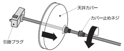
**3** 下図を参考に引掛プラグを天井の配線器具へ接続します。
