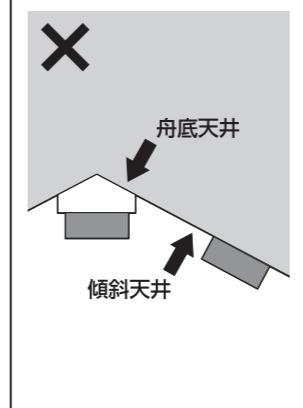
**4** 下図を参考に、天井の器具に固定金具を取り付けます。
