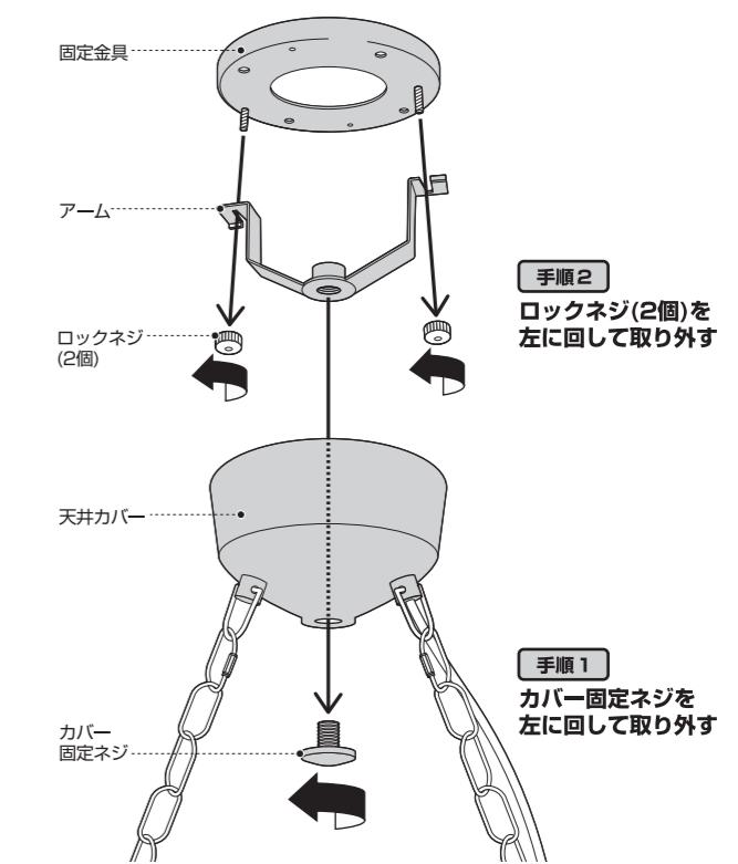
!**下図を参考に、天井の器具に固定金具を取り付けます。**
