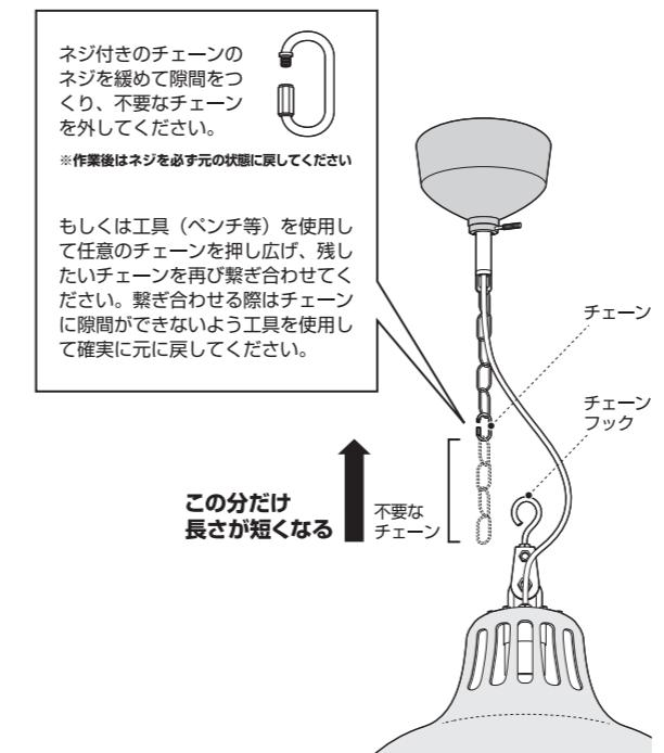
**6** 次に電源コードの長さを調節します。下図を参考にお好みの長さに調節し、コードクリップで固定してください。
