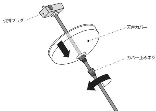
3 下図を参考に引掛プラグを天井の配線器具へ接続します。
