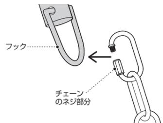
チェーンのネジ部分を緩めて隙間をつくり、フックに取り付ける
