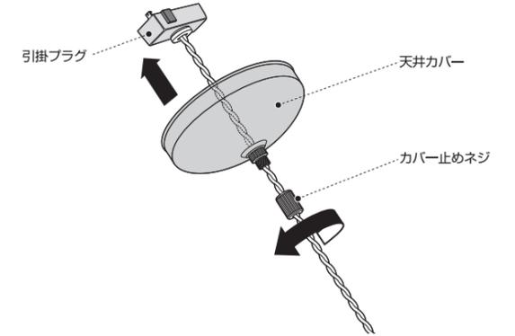
**5** 天井カバーを押し上げ、カバー止めネジを締め付け固定します。
