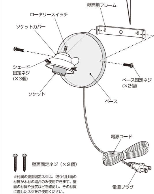
※付属の壁面固定ネジは、取り付け面の材質が木材の場合のみ使用できます。壁面の材質や強度などを確認し、その材質に適したネジをご使用ください。
