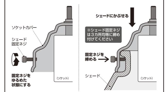
**注意** 固定ネジは慎重に締め付け固定してください。締め付けすぎるとシェードが破損する原因となりますのでご注意ください。作業完了後は、シェードとソケットカバーを上下左右に少し動かしてしっかりと固定されている事を確認してください。
