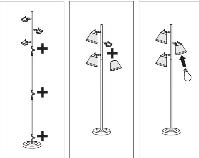
2 本体全体を平らな床などに寝かせた状態にしてください。下図を参考にし、①で組み立てたパイプにパイプ(上)を右に回して取り付けます。
