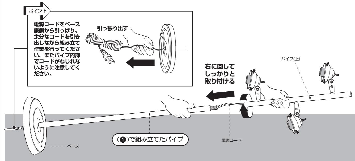
1 下記の手順を参考に、ベース、パイプ(下)、パイプ(中)を組み合わせてください。パイプは両手でしっかりと右に回し取り付けます。
