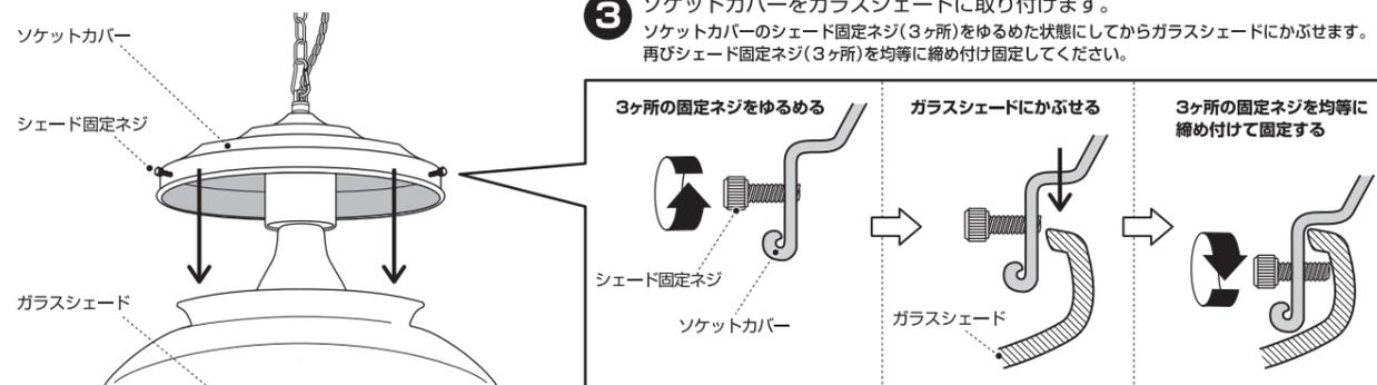
固定ネジは慎重に締め付け固定してください。締め付けすぎるとシェードが破損する原因となりますのでご注意ください。作業完了後はシェードとソケットカバーを上下左右に少し動かしてしっかりと固定されている事を確認してください。
