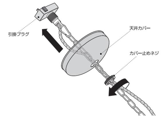
5 下図を参考に引掛プラグを天井の配線器具へ接続します。
