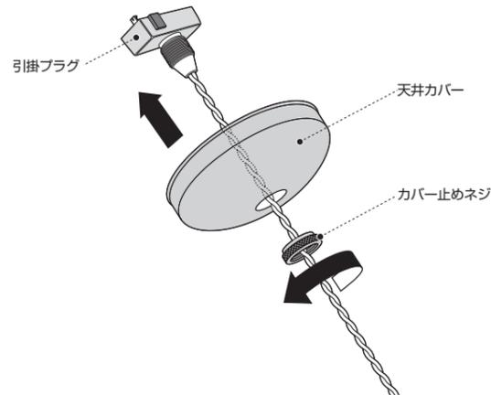
3 下図を参考に引掛プラグを天井の配線器具へ接続します。
