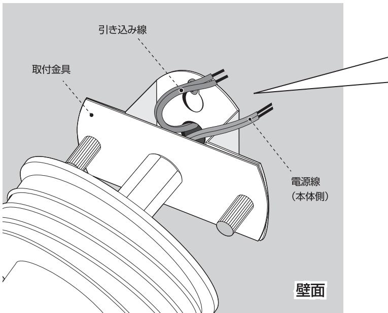
電源線と壁面内からの引き込み線を付属の接線端子でしっかりと接線します。
