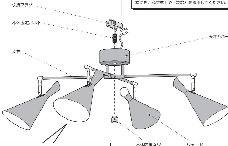
1 図を参考に、ソケットに電球をしっかりと取り付けます。
