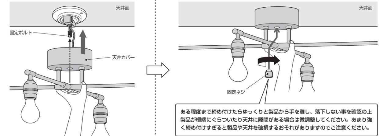
ある程度まで締め付けたらゆっくりと製品から手を離し、落下しない事を確認の上製品が極端にぐらついたり天井に隙間がある場合は微調整してください。あまり強く締め付けすぎると製品や天井を破損するおそれがありますのでご注意ください。
