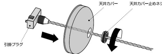
**2** 下図を参考に引掛プラグを天井の配線器具へ接続します。
