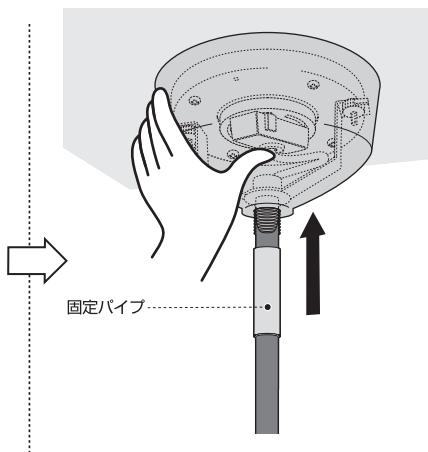
天井カバーに手を添えて、固定パイプを右に回しながら押し上げ、固定する
