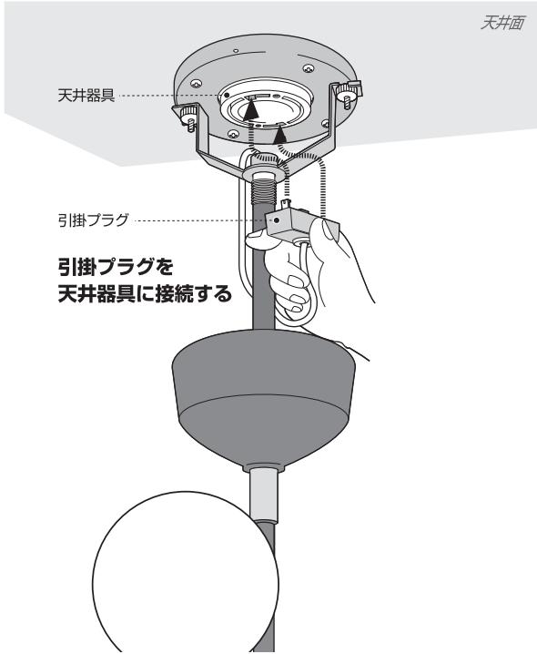
⑤ 天井カバーを押し上げ、固定パイプを右に回して押し上げていき、天井カバーと天井に隙間がなくガタつきの無くなる程度まで締め付けてください。
