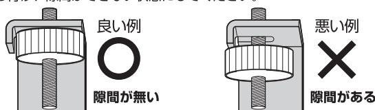
④ 下図を参考に引掛プラグを天井器具へ接続します。
