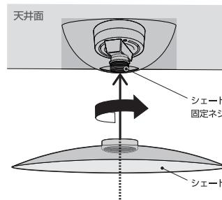
ソケットカバーを天井に押しつけたままシェードを右に回し、シェード固定ネジにしっかりと固定する
