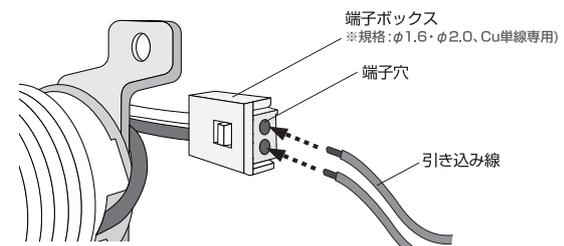
**配線の取り外し方** 下記を参考に解除ボタンを解除し、引き込み線を引き抜きます。
