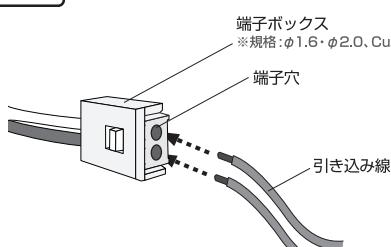
**配線の取り外し方** 下記を参考に解除ボタンを解除し、引き込み線を引き抜きます。
