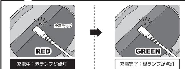
※フル充電までの所要時間は約3.5時間です。(電池の消耗状態によって変動します)
