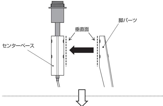
次に、それぞれのネジ穴の位置に注意しながら固定ネジを差し込み、付属の六角レンチで締め付けて、脚パーツをセンターべースに取り付けます。
