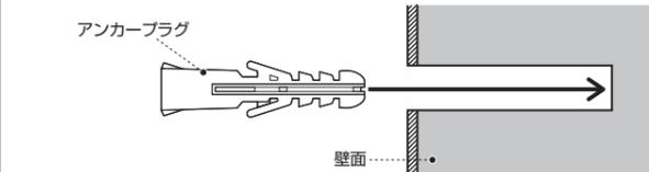
**2** 図を参考に製品の取り付け穴と壁面の穴を合わせ、ワッシャーとスペーサーを挟み、取り付けネジで壁面に固定してください。
